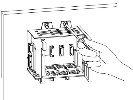
4. Deixando folga nos furos de fixação da esquerda e da direita para o aterramento instale os outros parafusos de fixação.
