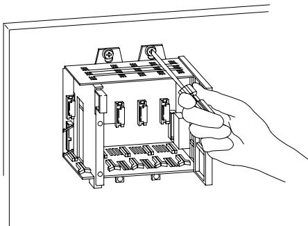
4. Lasciando le lingue più a sinistra e più a destra aperte per il collegamento alla terra, installare le rimanenti viti (per uno chassis a 4 slot, lasciare tutte e due le lingue aperte).
