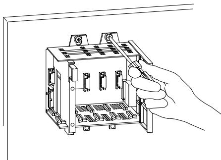
4. En laissant les pattes aux extrémités droite et gauche desserrées pour la mise à la terre, installez les vis restantes sur les autres pattes de fixation (pour un châssis à quatre emplacements, laissez les deux pattes desserrées).
