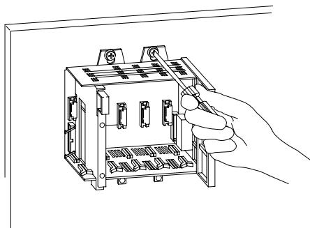
4. Lassen Sie die äußerst linke und äußerst rechte Lasche zur Herstellung einer Erdungsverbindung offen, und installieren Sie die restlichen Kleinteile (bei Chassis mit vier Steckplätzen müssen beide Laschen offen gelassen werden).
